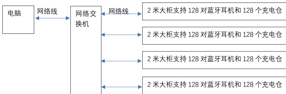
一台电脑最多控制 4 个 128 通道老化柜，共 512 通道
